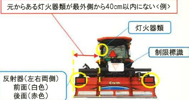
※道路運送車両の保安基準により、各種灯火器類の取り付け位置は以下のように定められています。
